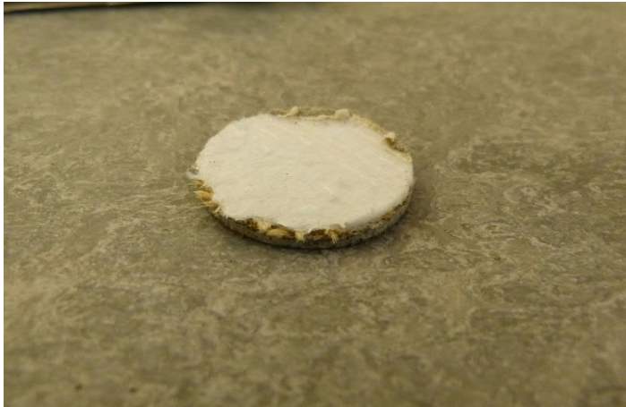
Bild 3: Förskola2 Lund av Forbo Marmoleum, Decibel 3, med tunn vit stegljudsmatta av polyolefin.
