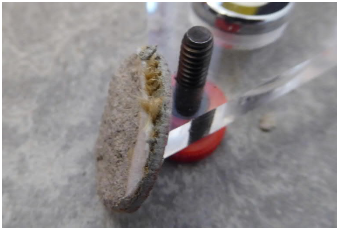
Bild 1: Linoleum med vävbaksida och en tunn vit stegljudsdämpare från Förskola1 Lund.
