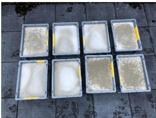
Bild 5. Härddning utomhus i två veckor under bar himmel. Därefter i carport i utomhusklimat i 10 veckor under tak.
