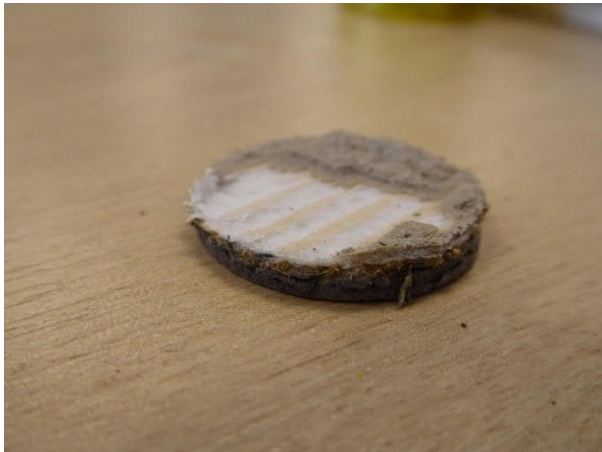
Bild 2: Lika uppbyggnad av mattan på Skola Dalby. Rester av avjämningskiktet sitter fast i mattan.
