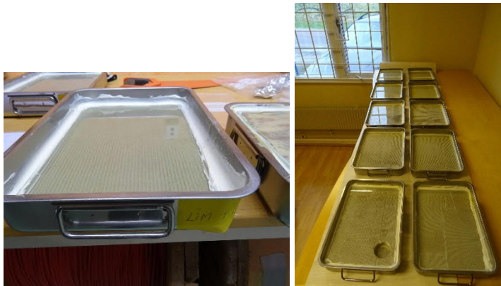
Bild 7: Limmad glasskiva i provform med silikonsträng utmed kanter. Bild 8: flera provformar.
