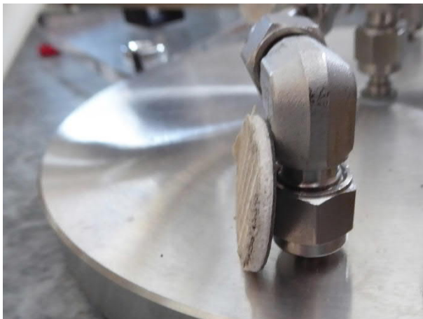
Bild 6: Matta Ehrenborg Acoustic från förskola Dalby. Baksidan till vänster i bild och den tunna ytbeläggningen till höger.
