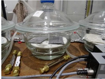
Bild 6: Mattprov under mätning med kammarmetoden.
