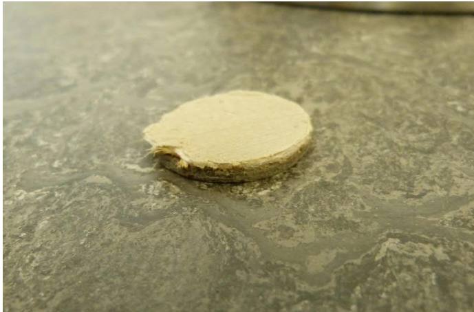
Bild 4: Skola Lund av Forbo Marmoleum med tunn vit stegljudsmatta av polyolefin. Limskiktet sitter kvar på mattprovet.
