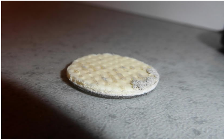
Bild 5: Mattprov från skola Burlöv med tunn PVC och 2mm stegljudsdämpare på baksidan.
