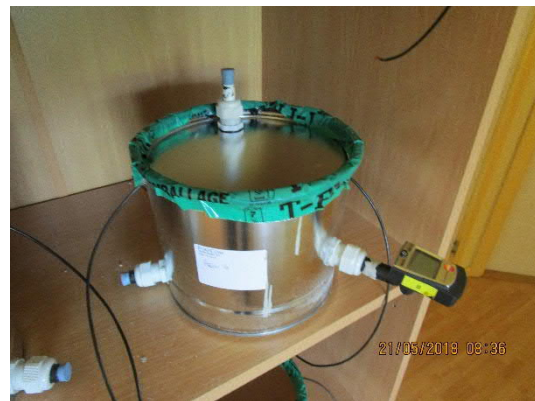
Bild 4. Efter montage och tätning av lock. Mätning av RF i betong pågår med Testogivare vid 40 % mätdjup.
