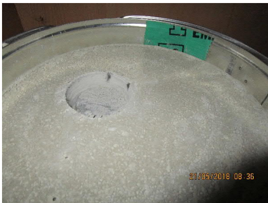
Bild 3. Mätning av relativ fuktighet i avjämningsmassa i referensprovkropp 3 genom uttaget prov.
