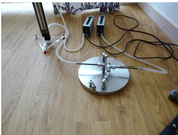
Bild 1: FLEC-uppställning vid mätning i fält. Rumsluften renas och pumpas in i FLEC-lockets ytterkant. Luften sköljer över provytan och suges ut från mitten av locket. En Tenaxadsorbent fångar VOC som avgått från provytan.
