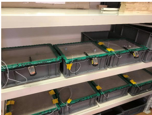
Bild 9. Provbackar med pågående mätning av relativ fuktighet i luftspalt.
