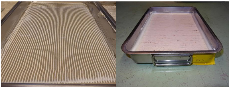
Bild 4: Lim i provform. Bild 5: Matta lagd med silikonsträng utmed kant.
