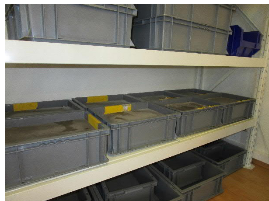
Bild 6. Förvaring inomhus i 2 veckor innan avläsning enligt RBK och applicering av avjämningsmassa.
